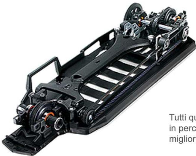
La trasmissione a 3 cinghie offre enormi vantaggi rispetto alla classica 2 cinghie. In questo modo, infatti, le batterie possono essere collocate al centro della macchina, migliorando così il bilanciamento della stessa. Oltre a questo, anche il motore è stato spostato verso il centro.
